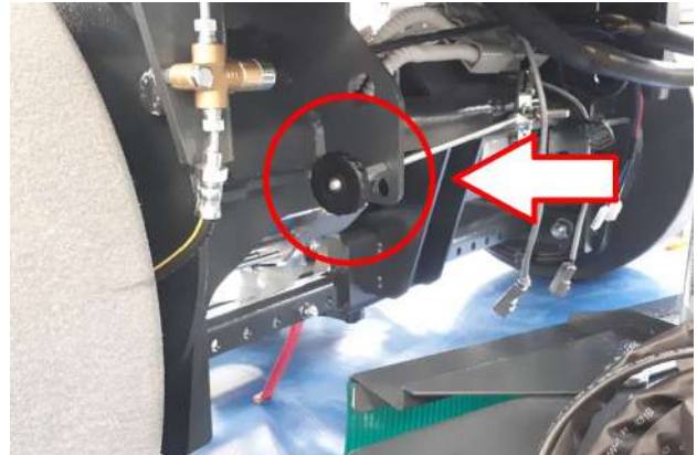
Frein électrique roue gauche Sur le côté droit de la machine, entre le carter et la roue arrière
